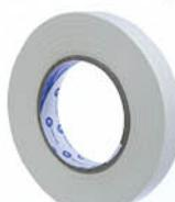
Fita adesiva com dorso de papel crepado (palha) e adesivo à base de borracha e resina vulcanizada. Temperaturas até 160°C.
