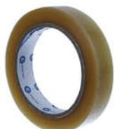
Fita adesiva com dorso em filme de poliéster com adesivo de borracha, alto tack, retardante a chama, resiste à ação de solventes e óleos, utilizada para altas temperaturas (130°C). Possui padrão UL e Rohs Free.
