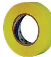
Fita adesiva com dorso em filme de poliéster com adesivo acrílico, retardante a chama, resiste à ação de solventes e óleos, utilizada para altas temperaturas (130°C). Possui padrão UL e Rohs Free.
