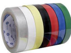
Fita adesiva com dorso em filme de poliéster com adesivo acrílico, retardante a chama, resiste à ação de solventes e óleos, utilizada para altas temperaturas (130°C). Possui padrão UL e Rohs Free. Várias opções de cores.
